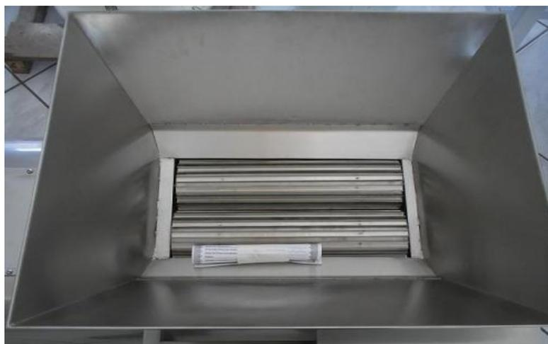
**Figura 4 – Máquina utilizada para o esmagamento da uva. Fonte: Jardinox (2011).**
