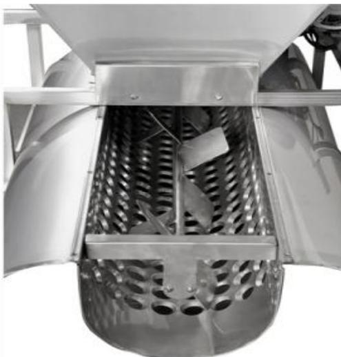
**Figura 5 – Máquina utilizada para triturar a uva. Fonte: Jardinox (2011).**
