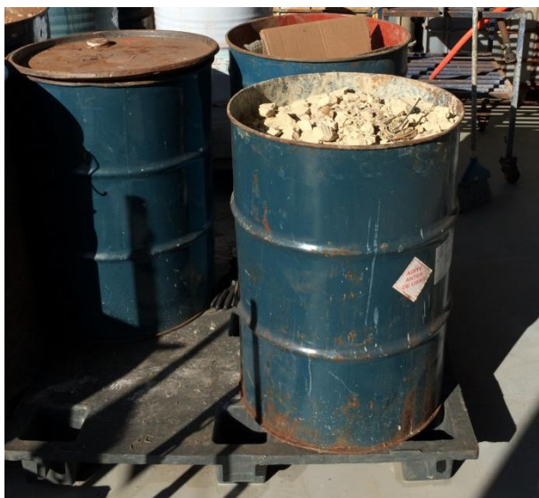
Figura 4: Tonel de ferro com lodo gerado pela estação de tratamento de esgoto.
